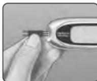
Das Messgerät schaltet sich ein, es wird eine Startanzeige und dann eine Codenumber angezeigt. Bei der ersten Verwendung des Messgeräts erscheint im Anzeigefeld [ "-- " anstelle einer Nummer.
