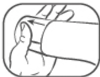
1. Transparente Schutzkappe abziehen
