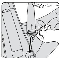
Para sustituir los resortes, abra el botón automático del cierre de la funda protectora del resorte y deslícela hacia arriba.
