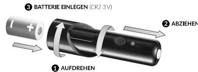
Zum Batteriewechsel muss die Schutzkappe und die Batteriekappe entfernt und nach dem Einlegen der Batterie wieder aufgesetzt werden (siehe Abbildung). Beim Aufsetzen der Batteriekappe ist zu beachten, dass das Logo „Herpotherm®“ und der abgeflachte Rand der Batteriekappe dieselbe Orientierung haben, damit das Gehäuse richtig geschlossen werden kann.
