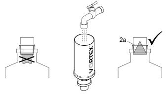
Falls notwendig, stülpen Sie das Ventil (2a) vorsichtig mit Hilfe eines Leitungswasserstrahls in die Ausgangsposition zurück und schütteln Sie danach das Wasser ab.
