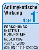
\* Notenspiegel 0 - 5. Note 0: kein Wachstum. Note 1: ohne Vergrößerungsgerät kein Wachstum sichtbar, aber deutlich sichtbar unter dem Mikroskop. Zum Vergleich unbehandelte Baumwolle Note 5: massives Wachstum, das die gesamte Prüfoberfläche bedeckt.
