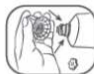
4. Applikator wieder auf die Tube drehen
