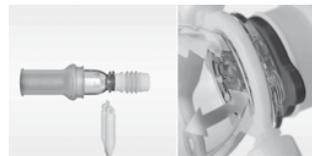
Beim Anbringen an die Glocke ist unbedingt zu beachten, dass der Wulst der Glocke in die Nut der Dichtmanschette am dicken Ende der Dichtmanschette einrastet. Wird die Dichtmanschette zu weit über den Wulst der Glocke gezogen, reißt die Dichtmanschette.
