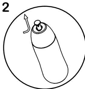
Sprühkopf aus dem Deckel des Bidets an der Einkerbung herausziehen.
