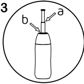
**Wichtig:** Prüfen, ob Sprühhals sichtbar vollständig ausgefahren wurde, um die Dichtungen zu schließen und Tropfen zu verhindern.
